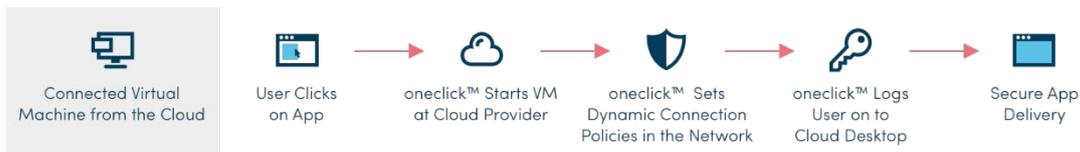
Beim Zugriff auf eine Virtuelle Maschine initiiert der Nutzer durch Klick auf die gewünschte Kachel im Workspace eine Aktion beim Cloud-Anbieter, z.B. den Start eines Desktops. oneclick™ startet anschließend die Virtuelle Maschine und setzt eine dynamische Netzwerk-Richtlinie, die nur Zugriffe aus oneclick™ zulässt. Nun loggt oneclick™ den Benutzer ein und die gewünschte Anwendung wird wiederum sicher als verschlüsselter Stream ausgeliefert.
